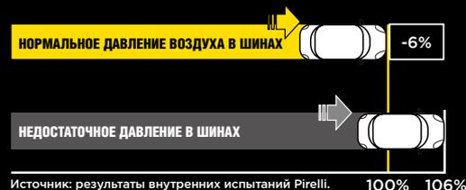
Тормозной путь в зависимости от давления воздуха в шинах.
