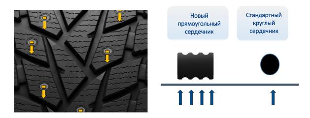
В соответствии с техническим регламентом CU-TR 018/2011 на погонный метр шин DUNLOP SP WINTER ICE02 и DUNLOP GRANDTREK ICE02 приходится 60 шипов. Для оптимального сцепления на скользкой поверхности шипы расположены в 16 рядов, что вдвое больше, чем на зимних шинах DUNLOP предыдущего поколения.
